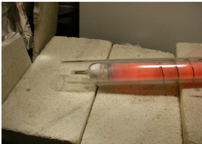
先端のセンサー位置と石英外管の状態
